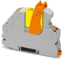
Vormontiertes Relaismodul mit Push-in-Anschluss, bestehend aus: Relaissockel, Sicherheitsrelais mit zwangsgeführten Kontakten gemäß DIN EN 61810-3, steckbarem Anzeige-/Entstörmodul und Haltebügel, Kontaktausführung: 2 Wechsler, Eingangsspannung: 24 V DC
